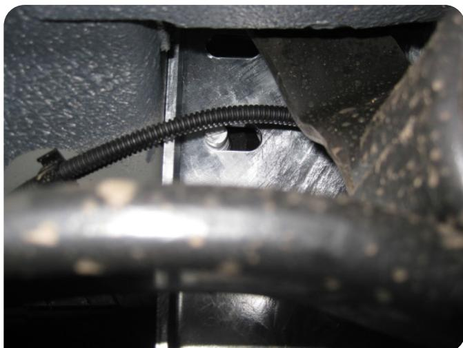
Die Halter werden mit dem mitgelieferten Befestigungsmaterial an den vorhandenen AHK-Befestigungsbohrungen montiert.
