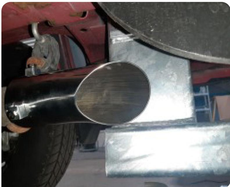
Wenn der Auspuff mit dem Halter der Trittstufe kollidiert oder knapp über dem Halter verläuft, empfehlen wir den Auspuff zu kürzen und das Auspuff Endstück (Artikel Nr.: 100816) anzuschrauben.
