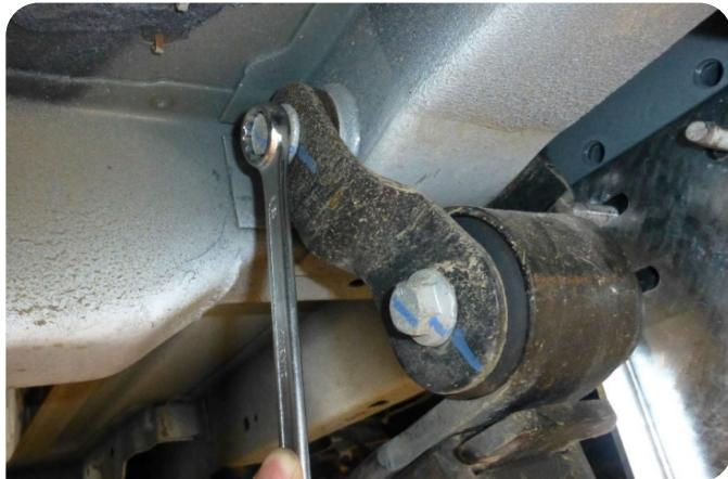
Tipp: Für die einfachere Montage das Ersatzrad absenken und die obere Schraube der Blattfedern-Lager einige Umdrehungen lösen.
