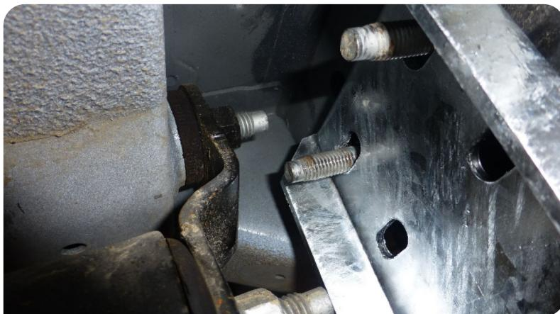
Die Halter werden mit dem mitgelieferten Befestigungsmaterial an den vorhandenen AHK-Befestigungsbohrungen montiert.
